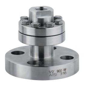
Projetados para isolarem os elementos sensíveis dos manômetros, pressostatos, transmissores de pressão dos fluidos de processo corrosivos, viscosos, sedimentados e com altas temperaturas e pressões. Uma membrana elástica, fechada mecanicamente e sobreposta com teste de vedação garantem a separação do fluido de transmissão daquele do processo. A vedação metálica da membrana garante a utilização do separador em alta temperatura eliminando o problema da vedação.
